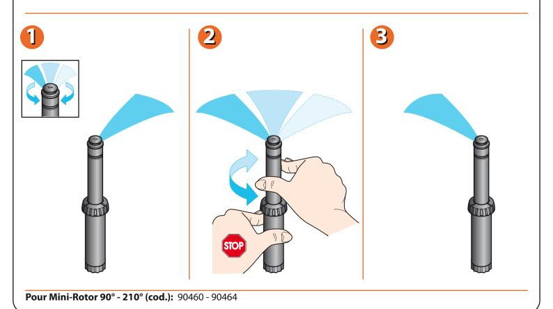
Pour modifier l'angle d'arrosage de 90° à 210° : tournez la bague rainurée en sens horaire pour l'augmenter, en sens antihoraire pour le diminuer.
