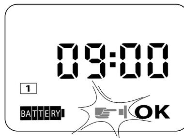
**IT PROGRAMMAZIONE PRIMA IRRIGAZIONE - Apertura.** Dopo aver impostato l'ora corrente, premere la freccia destra per entrare nella pagina del programma 1. Appare l'orario 00:00 preceduto da 1 (programma 1). Premere il tasto centrale ENTER. Sul display appare OK ad indicare che si può impostare l'orario di apertura utilizzando le frecce (es. 05:00); sul display, in alto, si visualizza 1 (programma 1). Confermare l'orario premendo ENTER.
