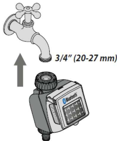
Installare il programmatore su un rubinetto domestico. Accertarsi che il rubinetto sia dotato di un attacco filettato maschio da 3/4" (se necessario usare un adattatore).
