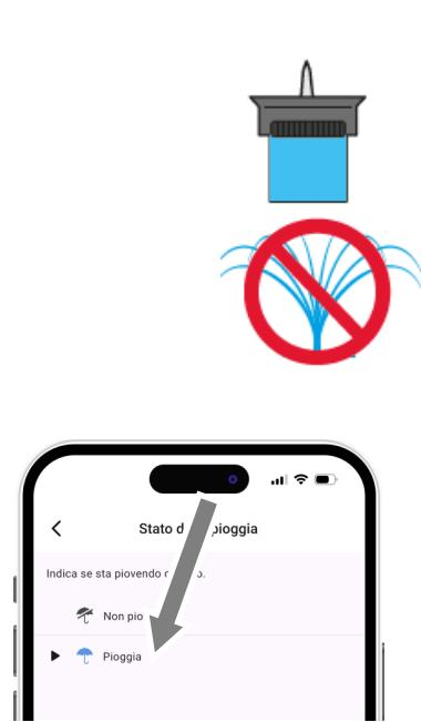
Il simbolo dell'ombrellino azzurro indica che il sensore di pioggia è pieno (pluviometria di almeno 5 mm/m<sup>2</sup>) esso dà il segnale di stop ai programmatore a cui è associato tramite App myClaber.
