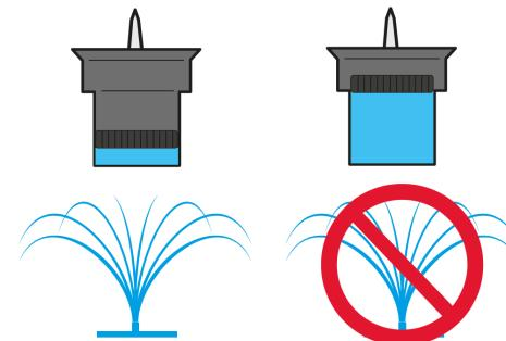
Il Rain Sensor comunica lo stato del sensore al programmatore: se il contenitore è pieno (pluviometria di almeno 5 mm), l'irrigazione non partirà e l'eventuale irrigazione in corso verrà interrotta entro 1 minuto. L'apertura manuale della valvola, sia da pulsante che da app, è abilitata anche con Rain Sensor attivo.
