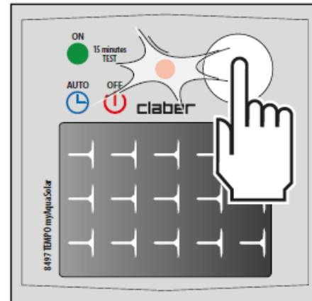
Per interromperla prima del suo completamento, premere più volte il tasto del programmatore per impostare lo stato desiderato: irrigazione automatica attiva (lampeggio LED blu) o irrigazione automatica non attiva (lampeggio LED rosso).
