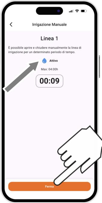
È possibile interrompere l'irrigazione manuale prima del suo completamento premendo FERMA.
