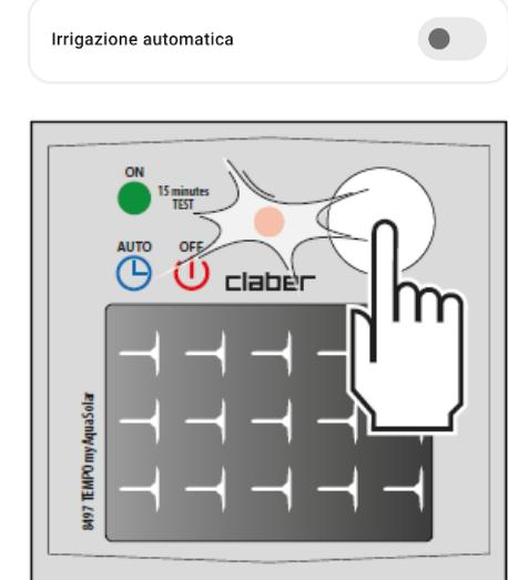
In alternativa è possibile anche agire sul pulsante presente nel programmatore. Premere una sola volta il tasto del programmatore per visualizzare il suo stato. Lo stato di irrigazione automatica attiva è individuabile da programmatore attraverso il lampeggio blu del LED; lo stato di irrigazione automatica non attiva dal lampeggio rosso. Premendo due volte il pulsante si andrà a cambiare lo stato dell'irrigazione automatica: attiva → disattiva oppure disattiva → attiva.
