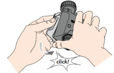
Una volta completata la carica, se era stato scollegato, ricollegare il modulo di comando. Sarà così possibile utilizzare il programmatore.
