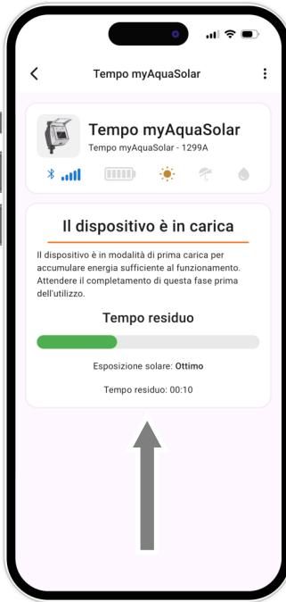
Verranno fornite le informazioni sullo stato di carica e sul tempo residuo al suo completamento (da 15 a 90 minuti a seconda dell'intensità luminosa presente).
