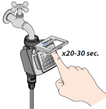
Se il programmatore si comporta in modo anomalo è possibile resettarlo. In reset NON cancellerà i programmi impostati e nemmeno la data e l'ora, ma eseguirà solo un riavvio della scheda elettronica. Prima di eseguire un reset assicurarsi di essere in una zona luminosa per permettere il riavvio del programmatore. Non eseguire mai un reset quando il programmatore sta irrigando: il flusso d'acqua potrebbe non arrestarsi.
