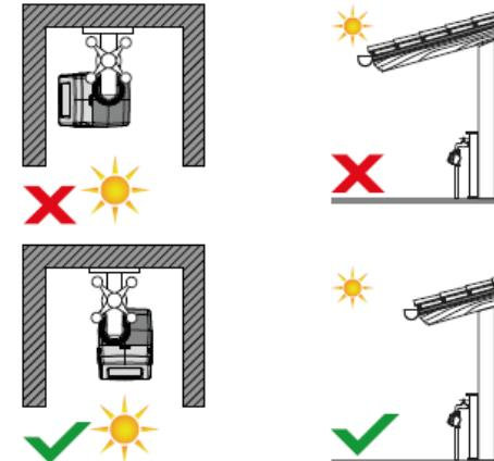
Una volta installato il programmatore, assicurarsi che il pannello fotovoltaico punti in direzione dell'area aperta da cui proviene la maggior quantità di luce nell'arco della giornata, in modo da assicurarne il corretto caricamento.
