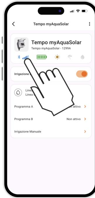
Le icone in ordine rappresentano: segnale Bluetooth®, livello di energia, irraggiamento solare, Rain Sensor ed irrigazione in corso.
