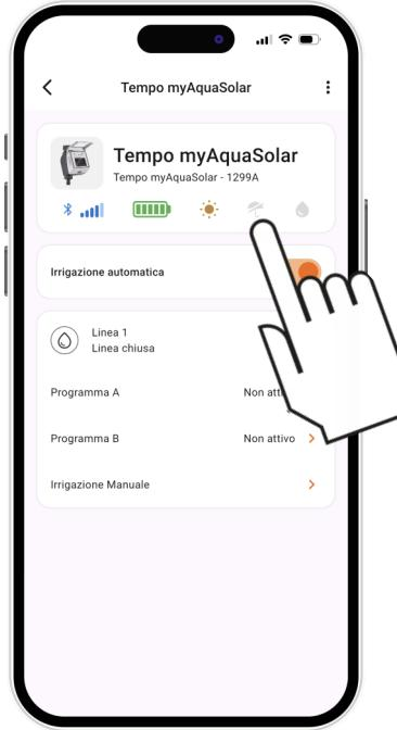
Lo stato del sensore di pioggia può essere visualizzato sulla barra superiore, con l'icona dell'ombrellino.
