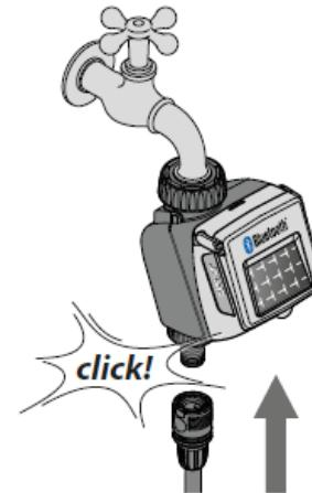
Collegare la linea di irrigazione alla presa del programmatore utilizzando un raccordo Quick-Click System oppure un raccordo filettato 3/4".
