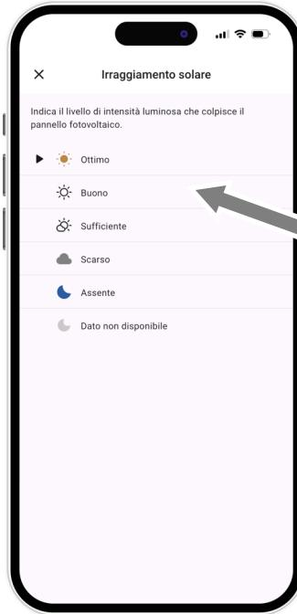
Dettaglio sulla qualità dell'irraggiamento solare.
