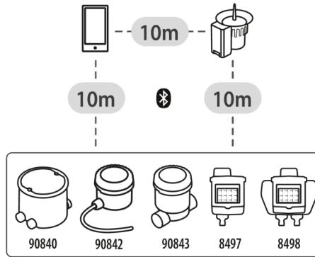
Per l'installazione, assicurarsi che la posizione scelta permetta al sensore di pioggia di comunicare con tutti i dispositivi da controllare, ogni Rain Sensor può comunicare con un massimo di 8 programmatori.
