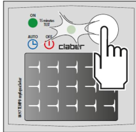
Per attivare l'irrigazione manuale da programmatore premere più volte il pulsante di Tempo myAquaSolar finché il LED lampeggia di verde. In questo caso si avvierà un'irrigazione manuale di 15 minuti.
