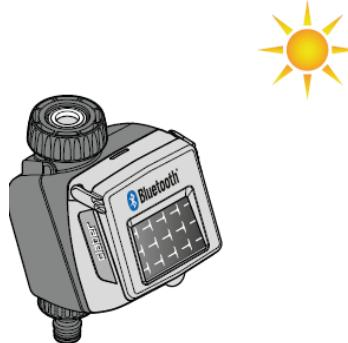
Se l'icona livello di energia è grigia, posizionare il programmatore con il pannello fotovoltaico esposto alla luce diretta del sole.
