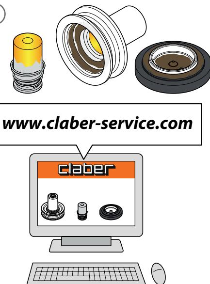
**IT** Rimontaggio: collocare la membrana nella sua sede, inserire il pistone con molla nella boccola e reinserire la boccola. Inserire la staffa con magnete, stando attenti che la parte del magnete rivolta verso l'esterno sia di colore bianco. Con un cacciavite torx 10 avvitare le quattro viti, dando prima un quarto di giro indietro per prendere il filetto.
