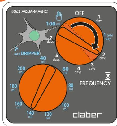
Gire el selector "FREQUENCY" (frecuencia) **hasta la posición inicial** (ej. 1 day): **la programación anterior se mantiene memorizada**, de manera que los riegos comenzarán a las horas habituales. Al girar el selector para ponerlo en la frecuencia anterior, no se detenga más de 3 segundos en otra frecuencia, ya que de lo contrario se tomaría como nueva programación.
